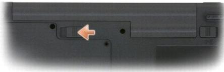
4. 右のバッテリーベイリリースラッチをスライドさせ、バッテリーベイからバッテリーを引き出します。
